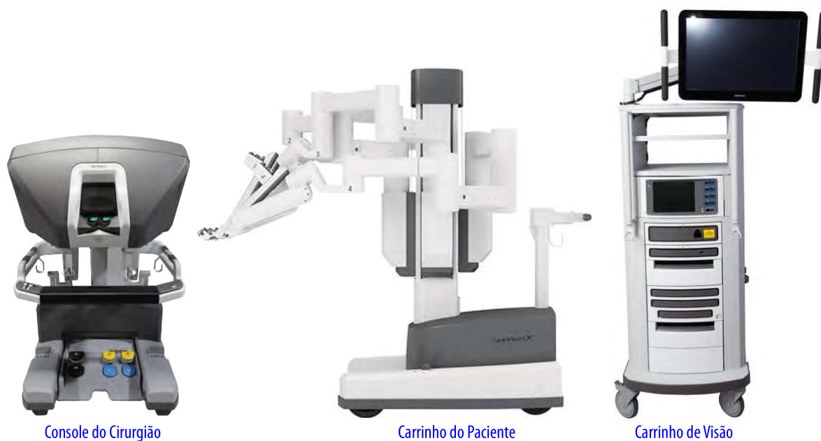
Figura 2.1 Principais componentes do sistema da Vinci X
